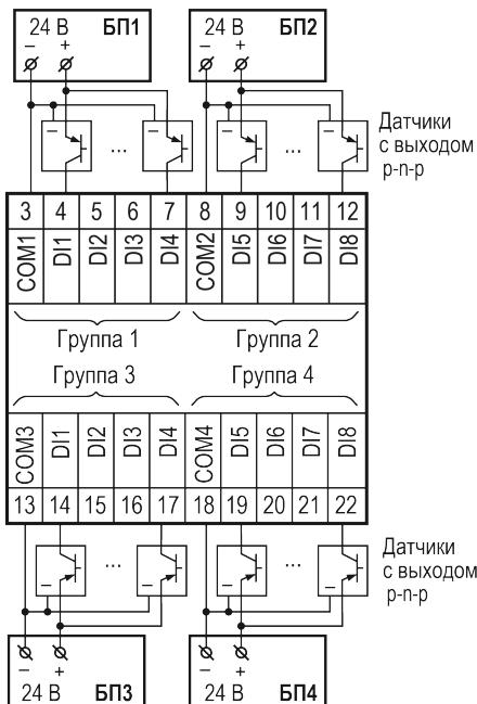
Рисунок 5.8 – Схема подключения датчиков с выходным транзистором р-п-р-типа
